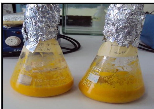
Figure 14 Milieu de fermentation à base de déchets d'oranges.
