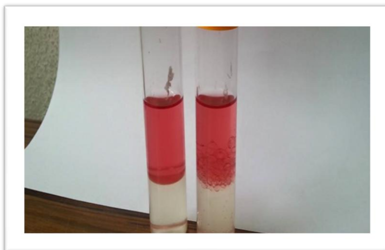
Figure 17. Test d'émulsification du kérosène après 24h.
