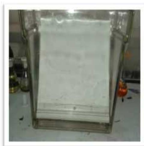
**Fig. 13:** développement d'une plaque CCM
