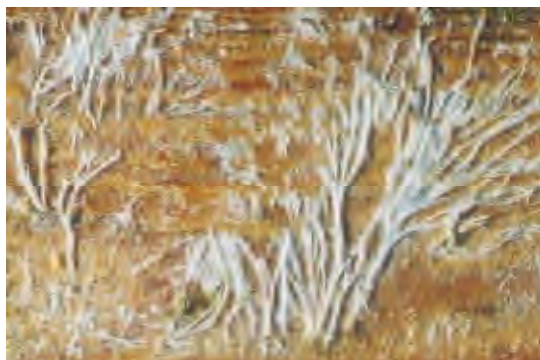
Figure 05 : Mycélium de la pourriture blanche sur du bois de sciage ( http://www.alliancesudexpertise.com/insectes-a-larves-xylophages-parasites-du-bois.php )
