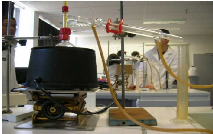
Figure 08 : Système d'extraction hydrodistillation (Laboratoire d'Obtention de Substances Thérapeutiques LOST)
