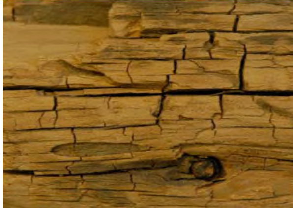
Figure 06: La pourriture molle, (ressemblance avec la pourriture brune). ( http://www.alliancesudexpertise.com/insectes-a-larves-xylophages-parasites-du-bois.php )
