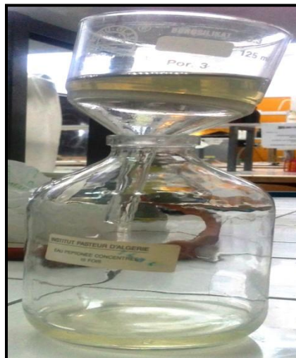
Photographie 2 : Filtration par filtre de silice.
