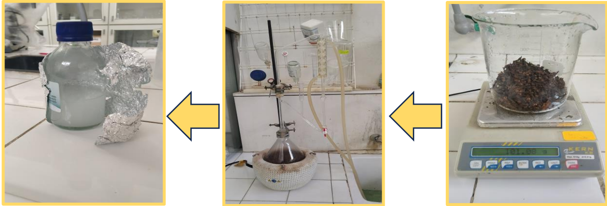
الشكل 24. مراحل إستخلاص الزيت الأساسي لقرنون القرنفل بواسطة جهاز Clevenger (صور حقيقية 2024)
