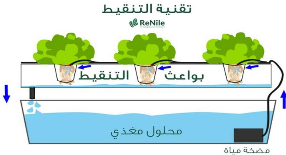
الشكل 9 : رسم توضيحي لنظام التنقيط ( site 7 )
