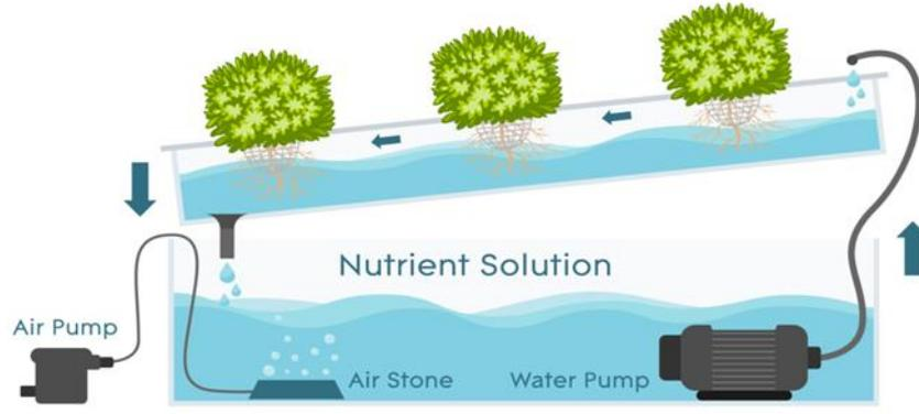
الشكل 14 : رسم توضيحي لنظام تقنية الأغشية المغذية
