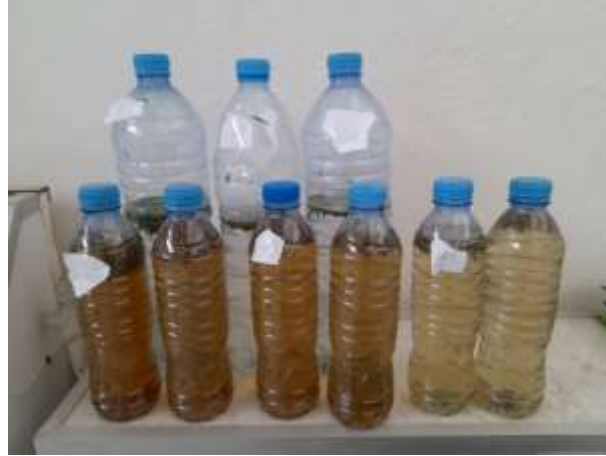
الصورة ( 11 ): تراكيز 10غ/ 8غ/ 4غ من نبات الخزامى / إكليل الجبل في 1 لتر ماء مقطر - بعد مرور 24 ساعة قمنا بترشيح المزيج عدة مرات حتى يكون جاهزا للاستعمال.
