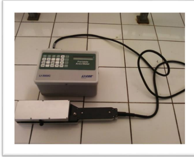
شكل (15): جهاز قياس المساحة الورقية (Li 3000 C) Portable Area Meter
