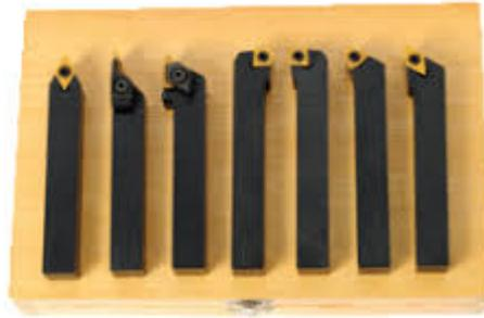
*Fig 12. Outils à plaquettes carbures*
