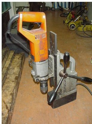
Fig 36. Perceuse à socle magnétique
