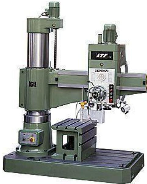
Fig 36. Perceuse radiale
