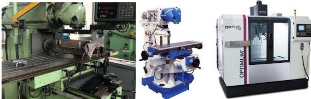
Fig 21. Différents types de fraiseuses
