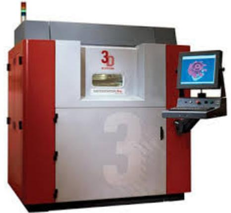
*Fig 49. Machine Frittage Sélectif Laser (SLS)*
