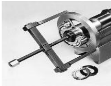
Figure1 : Un roulement à rotule sur une rangée de rouleaux est arraché au moyen d'un dispositif d'extraction
