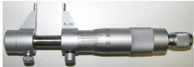
Micromètres Palmer d'intérieur
