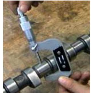
**Méthode indirect :** C'est le relevé à l'aide d'un capteur de l'écart entre une pièce à mesurer et un étalon (pièce de référence).
