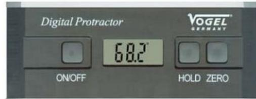
Inclinomètre digital électronique
