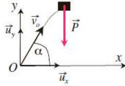
Pour calculer la distance parcourue par le palet lorsqu'il touche le sol on impose  $y = 0$  et on calcule le temps  $t$  de vol du palet.
