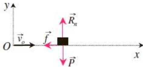
Principe fondamentale de la dynamique :  $\vec{P} + \vec{f} + \vec{R}_n = m \vec{a}$
