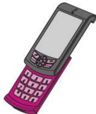
Exemple de liaison glissière : un téléphone portable dont la partie supérieure coulisse sur la partie inférieure.
