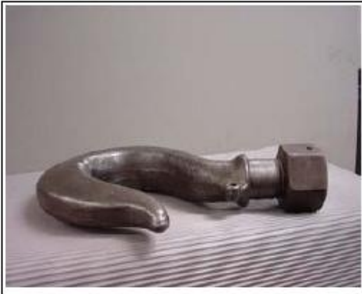
Fissuration en service d'un crochet
