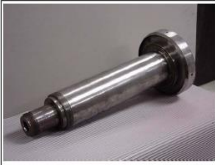
Fissuration induite par un traitement thermique
