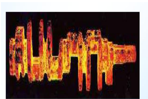
Exemple de pièce forgée à chaud : vilebrequin
