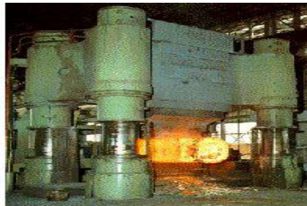
Opération de forgeage sur presse de 4500 tonnes (document AUBERT & DUVAL)
