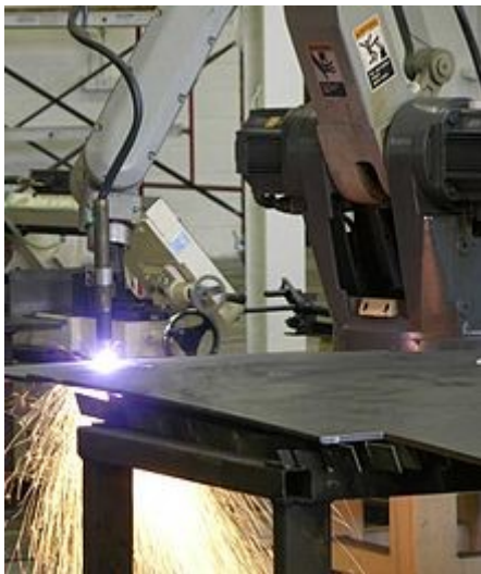
Découpage plasma réalisé par un robot industriel.
