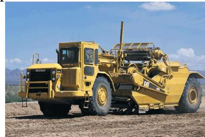
Par le biais d'une chaîne élévatrice, il se charge et se décharge par ses propres moyens.
