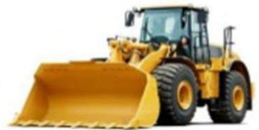
Les imposantes roues du chargeur, mûes par un moteur puissant, permettent la pratique de tous types de terrain suffisamment durs et une poussée importante vers l'avant.
