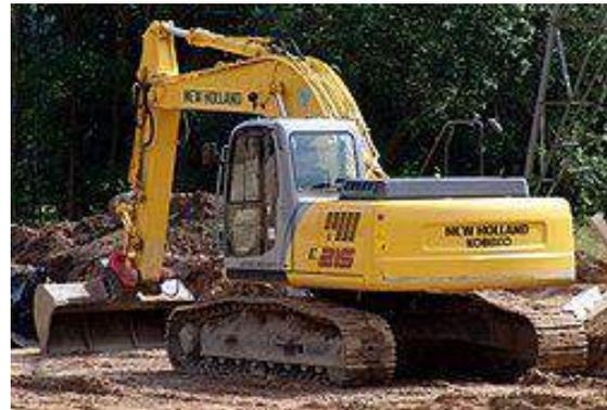
De même, plus les chenilles sont larges, plus l'usure des chenilles augmente et plus on abîme le terrain dans les virages. L'énergie nécessaire au virage augmente également.
