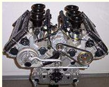
Figure V.5: Moteur V6 moderne (Mercedes)
