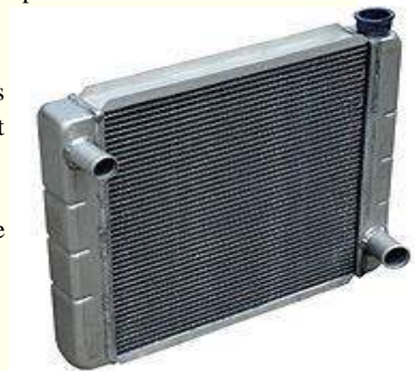
Radiateur moderne, en aluminium
