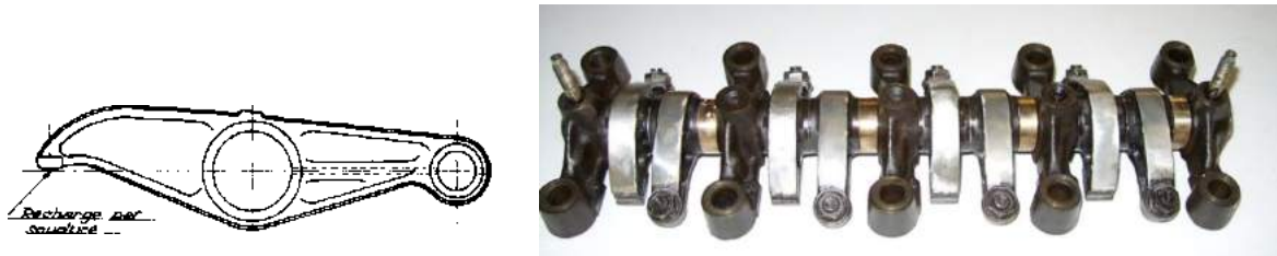
Figure. I.14: Culbuteurs Renault 21 TD
