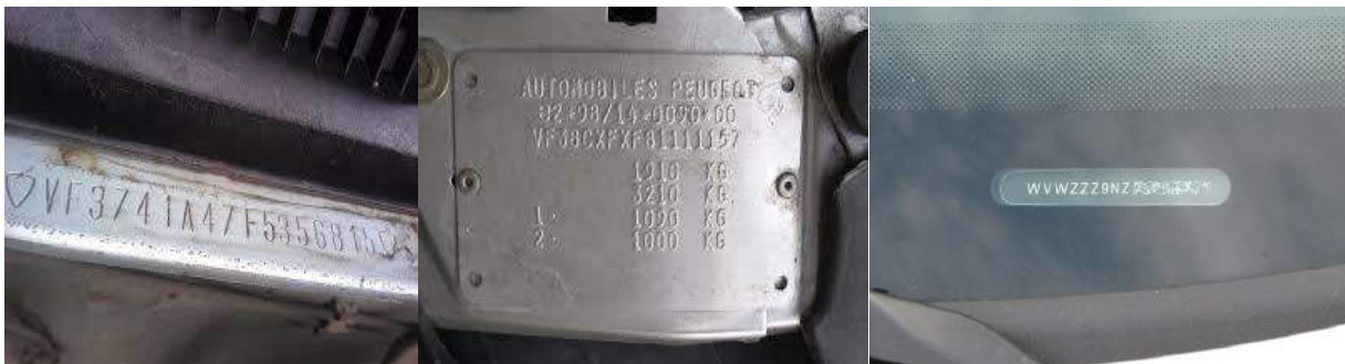
châssis du véhicule
