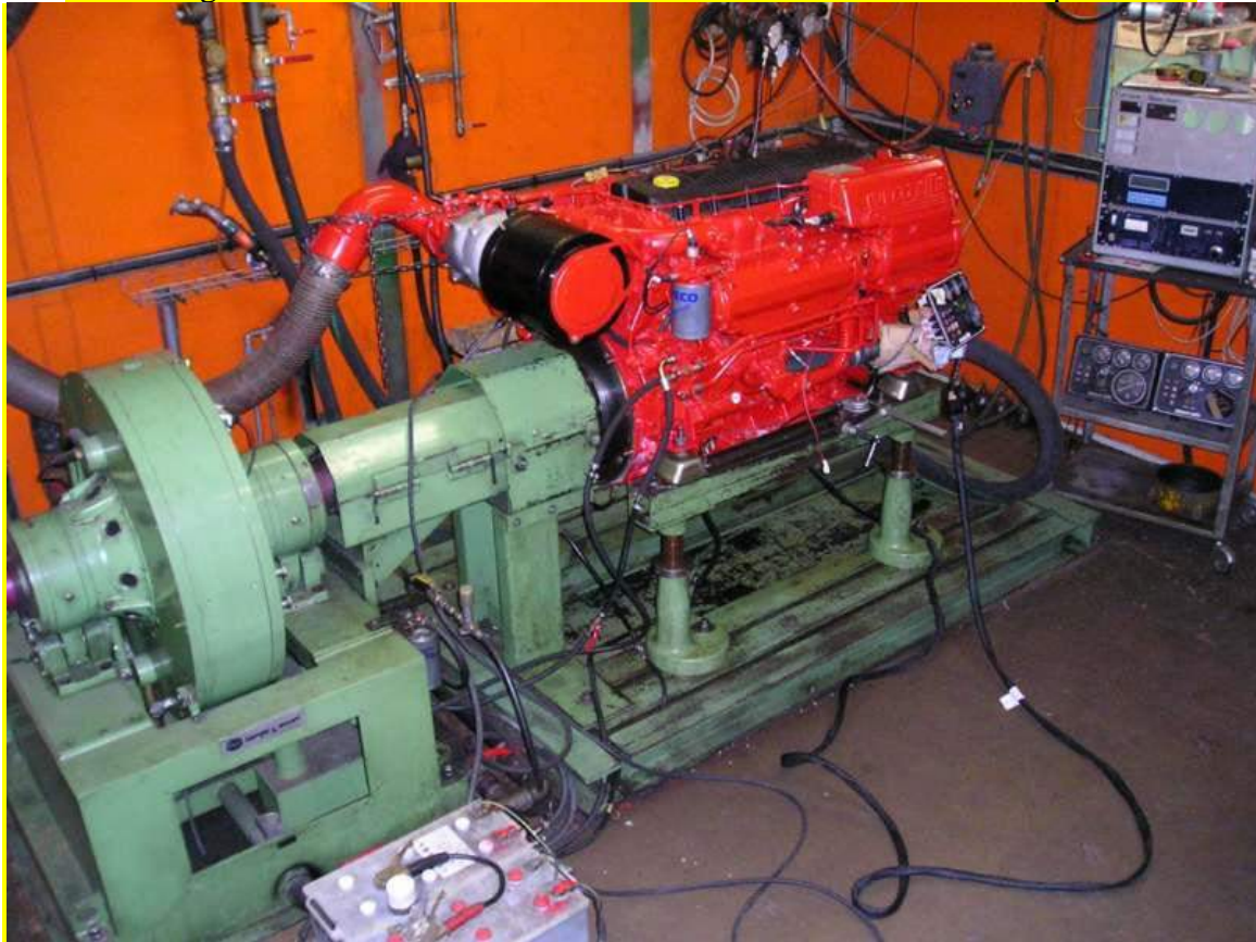
Banc d'essai moteur
