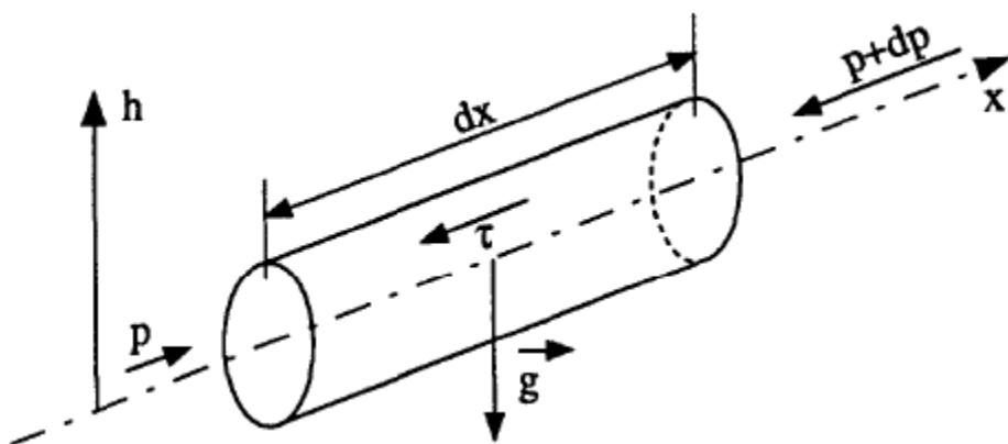
L'écoulement est supposé permanent et les variables  $p$  (pression) et  $u$  (vitesse) sont uniformes dans une section droite du tube.
