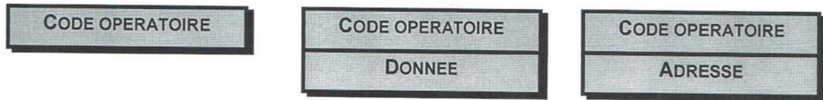
Fig. 10 Formats d'une instruction dans un microprocesseur
