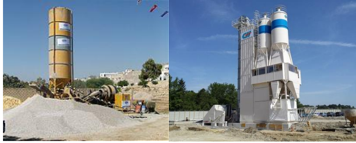
Fig.II.3. Centrale à béton
