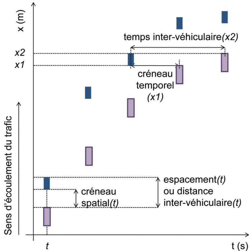
**Figure 2-5** : trajectoires de deux véhicules : un véhicule leader et son véhicule suiveur. On a représenté le créneau temporel (temps qui sépare le passage de l'arrière du leader de l'avant du suiveur en un point) et le temps inter-véhiculaire ; le créneau spatial et la distance inter-véhiculaire.
