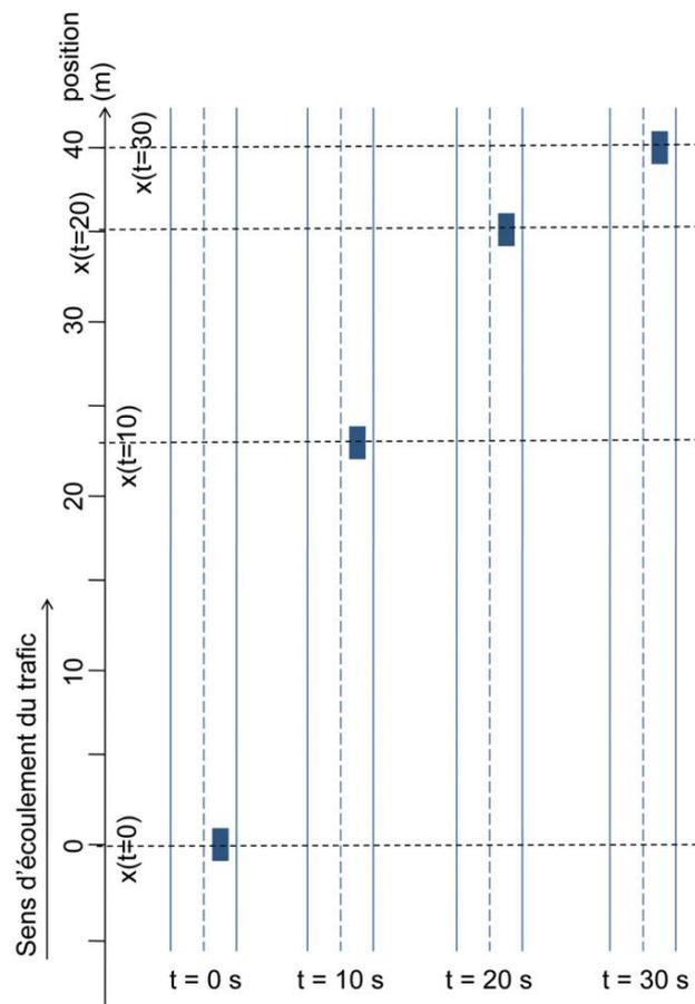
**Figure 1-1 :** position sur la voie d'un véhicule à quatre instants différents.
