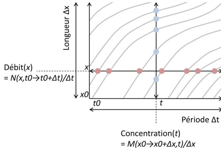
**Figure 1-6** : illustration de la différence entre vitesse moyenne temporelle calculée sur la base de la vitesse individuelle des véhicules passant en un point pendant une période  $\Delta t$  (vitesses figurées en rouge) et vitesse moyenne spatiale calculée à partir des vitesses individuelles de tous les véhicules présents sur une longueur  $\Delta x$  (figurées en bleu).
