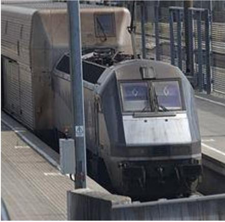
Le gabarit des navettes Eurotunnel, en comparaison avec celui de la locomotive, s'explique dans le cas d'un matériel dédié.
