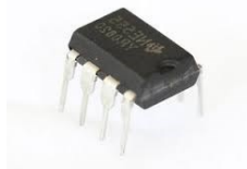
Figure 1 : Photo d'un boîtier de NE555, son brochage et ses principales caractéristiques.
