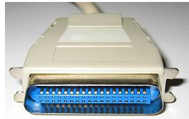
Connecteur Micro Ribbon à 36 pins
