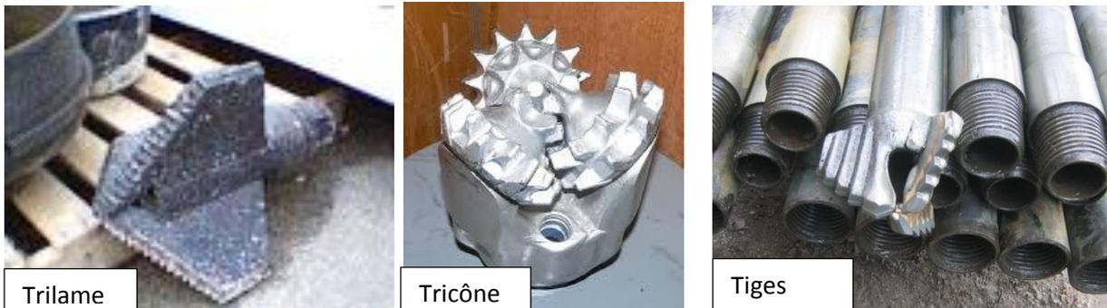
Figure 1: de gauche à droite : Trepan (Trilame et tricône) et tige (portant un filetage mal et femelle pour les raccorder les uns avec les autres, la première tige est raccorder à un Trilame)
