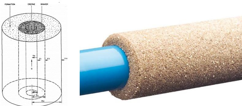
Figure 22: Le massif filtrant en gravier
