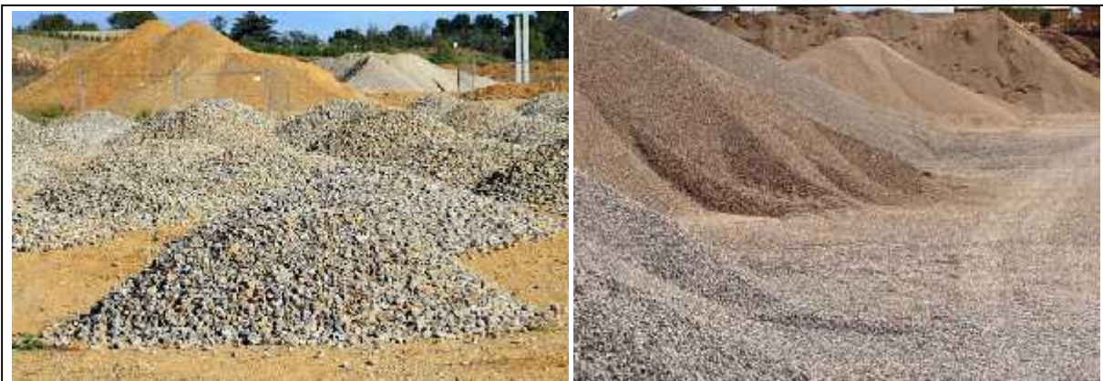
Figure 1.2 : Photos montrant les différentes classes granulaires pour la confection des bétons
