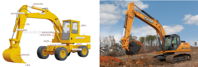
La pelle hydraulique
