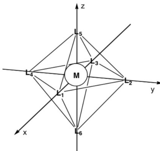
Les ligands  $L_1$  à  $L_6$  sont situés aux sommets d'un octaèdre régulier. l'interaction électrostatique (ici la répulsion) ne sera pas la même, sur un électron qui occupe une orbitale  $d_{z^2}$ , ou  $d_{xy}$ .
