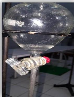
**Figure 19 : séparation de la phase chloroformique à l'aide d'une ampoule à décanter**
