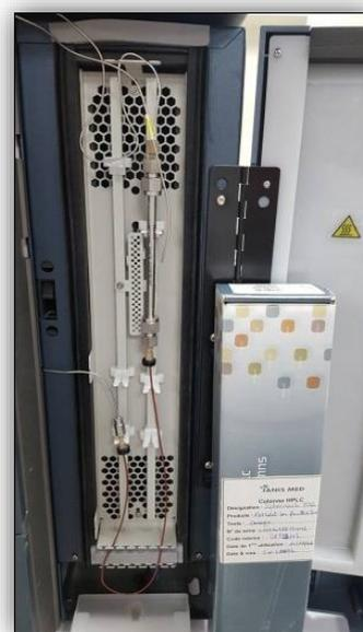
**Figure 27 : colonne d'HPLC**
