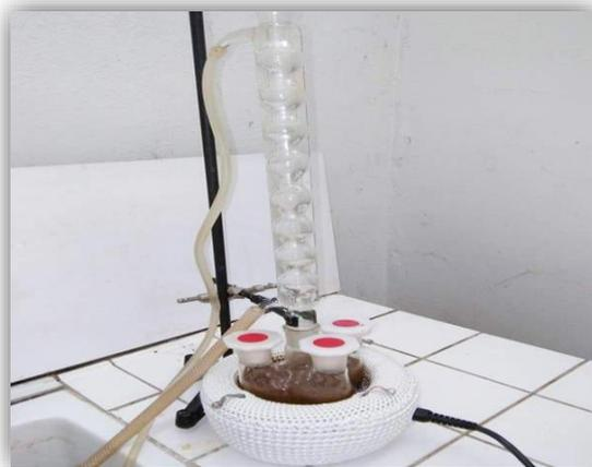
**Figure 20 : le chauffage à reflux utilisé pour l'extraction**
