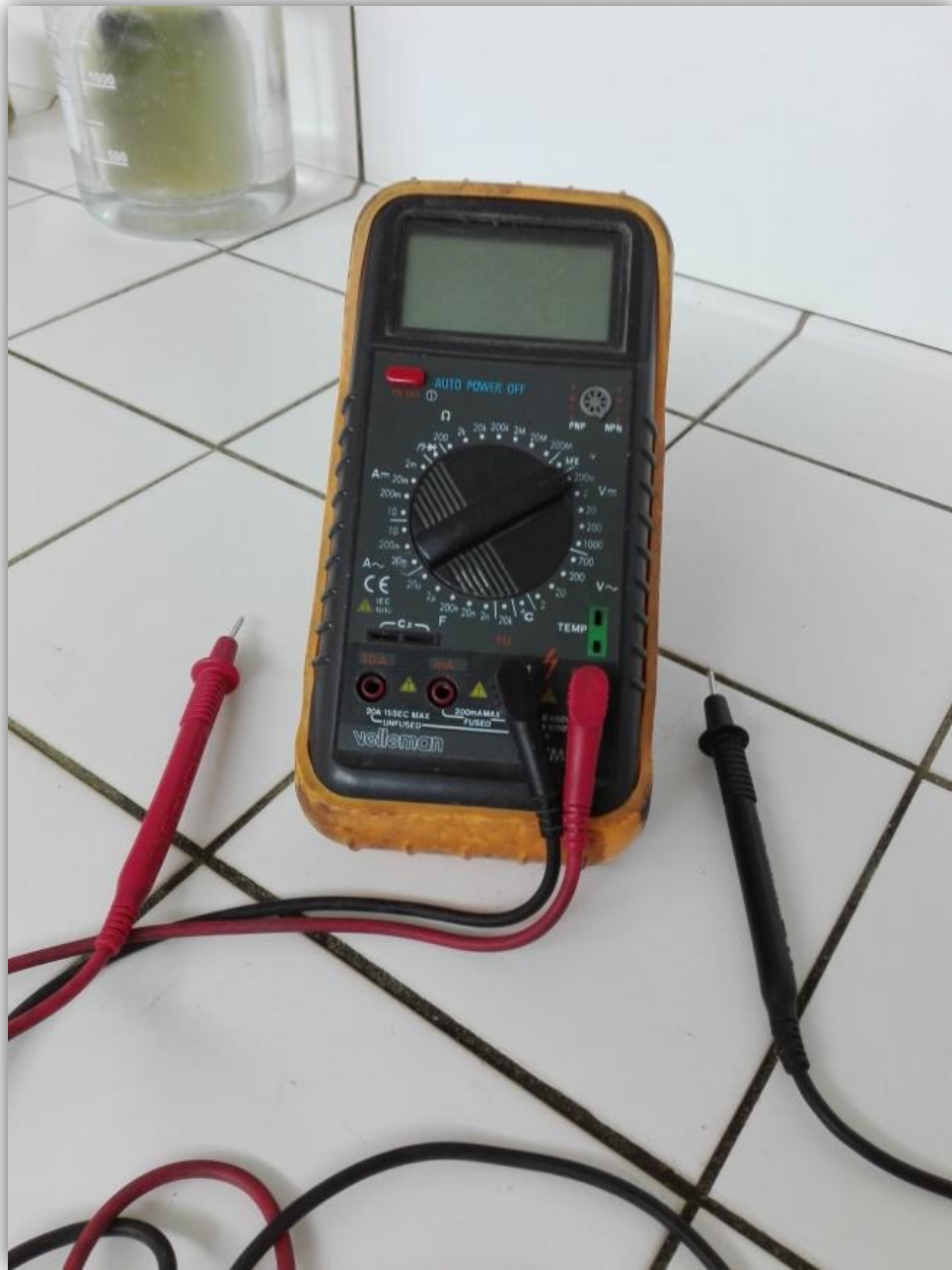
Figure 18 : le multimètre utilisé pour la mesure du courant électrique produit au sein de la PACM.
