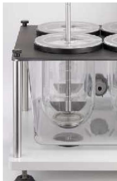
**Figure n° 13** : Dissolu teste de type palette.
