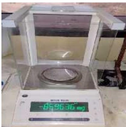
**Figure n° 11** : Balance de pesé.
