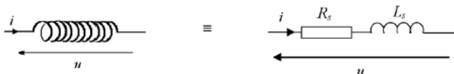
Figure 1. Modèle série d'une bobine réelle
